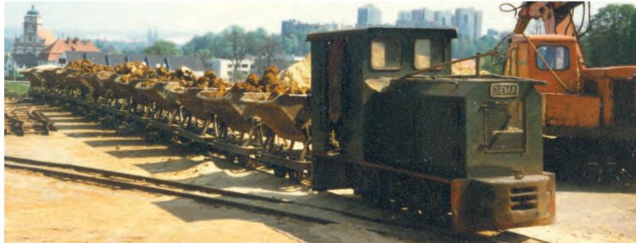
Die Lorenbahn für den Transport der Rohstoffe zum nahen Fabrikgelände
